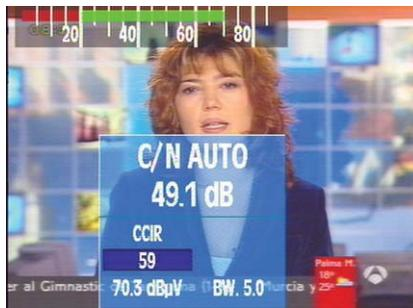
Figura 68.- Indicación C/N mediante barras
