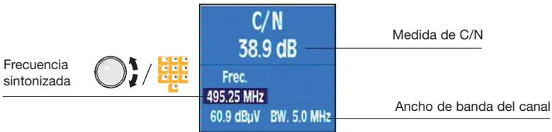
Figura 67.- Medida C/N automática. Sintonía por frecuencia
