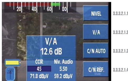
Figura 65.- Indicación V/A mediante barras
