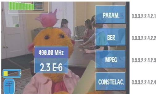
Figura 87.- Decodificación MPEG de un canal QAM
