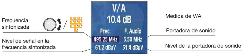
Figura 64.- Medida V/A. Sintonía por frecuencia
